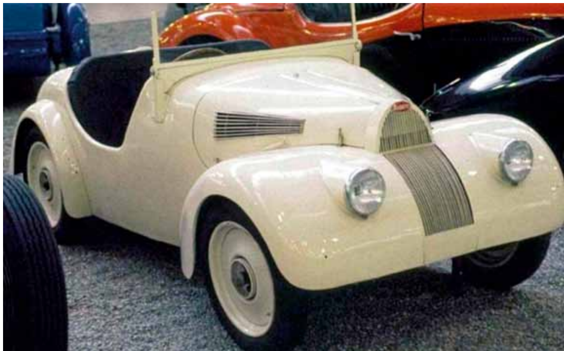
L'unico prototipo della Tipo 68 realizzato durante la guerra. La piccola vettura, dotata di un motore sovralimentato di soli 370 cm 3 , molto sofisticato, non ha avuto seguito produttivo.
