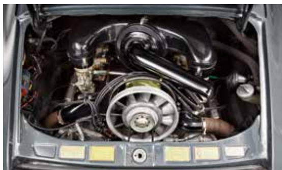
Il propulsore a 6 cilindri di 2000 cm 3 montato sulla prima 911 del 1964, da notare la grossa ventola per il raffreddamento dei cilindri e la scatola del filtro aria.
